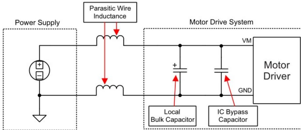
图 8. 外置电源电机驱动系统的设置
