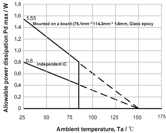
图 2 eTSSOP28 with PAD 额定参数曲线图
